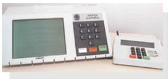
Slika 1. Elektronski uređaj za glasanje. Lijevo je terminal glasača, a desno terminal člana biračkog odbora Izvor: Vrhovni izborni sud u Brazilu: https://www.tse.jus.br/eleicoes/urna-eletronica/urna-eletronica
